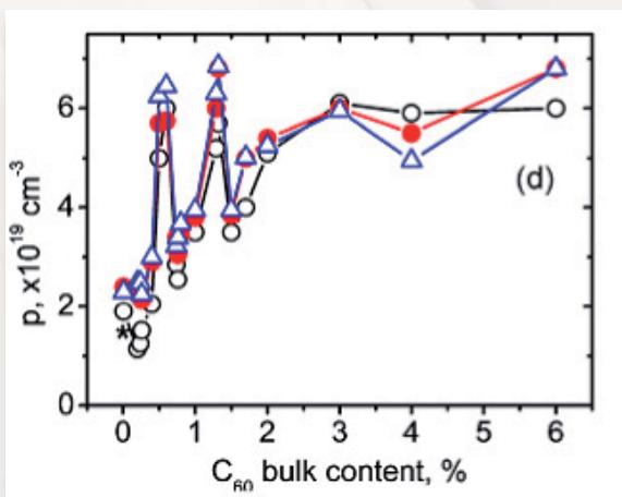
Зависимость концентрации свободных носителей заряда (дырок) от концентрации фуллерена  $C_{60}$  в сплаве  $Bi_{0.5}Sb_{1.5}Te_3-C_{60}$
