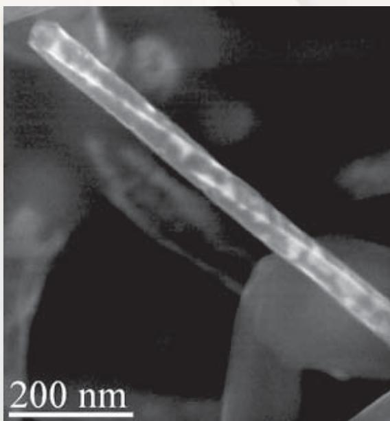
Ограненная и закрученная нанотрубка состава бор-азот-углерод
