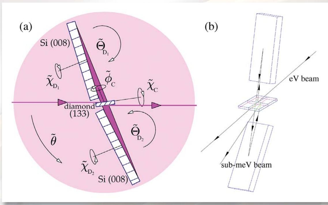
Оптическая схема гибридного монохроматора с рекордно малой спектральной чувствительностью
