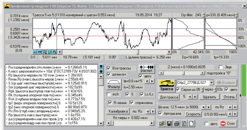
Панель управления, профиль рельефа, параметры шероховатости
