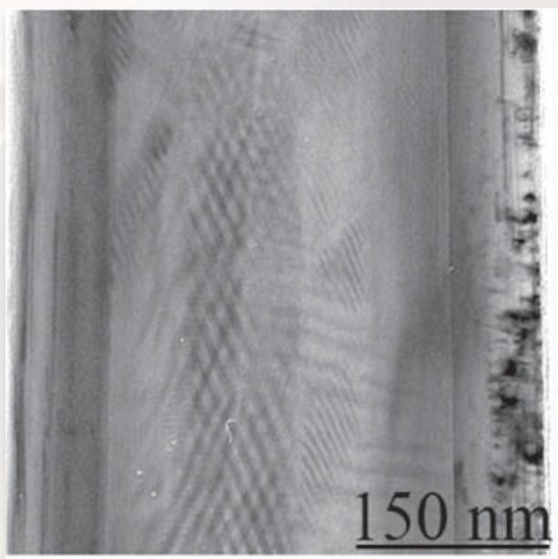
Ограненная нанотрубка состава бор –азот-углерод.
