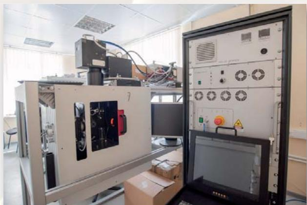
Комплекс лазерной обработки на основе пикосекундного лазера Lumera для размерной резки, заточки и изготовления изделий из сверхтвёрдых материалов.
