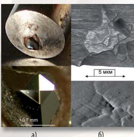
а) Фотография индентора Виккерса, изготовленного из ультратвердого фуллерита
