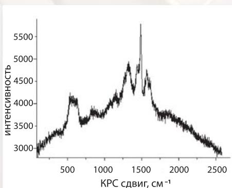
Впервые получены углеродные луковичные структуры при воздействии высоких давлений и сдвиговой деформации на графит в алмазных камерах высокого давления. Методом комбинационного рассеяния света показано, что полученные углеродные луковицы имеют структуру фуллеренового типа.
