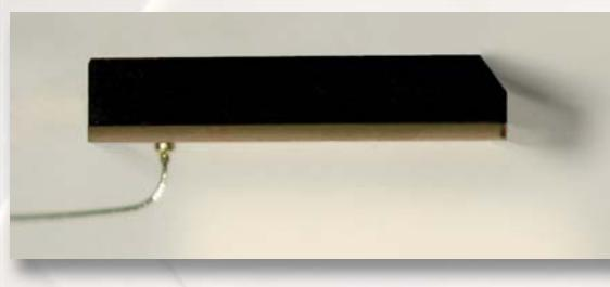
Чувствительные элементы датчиков ионизирующего излучения из монокристаллов CVD на легированных алмазных подложках
