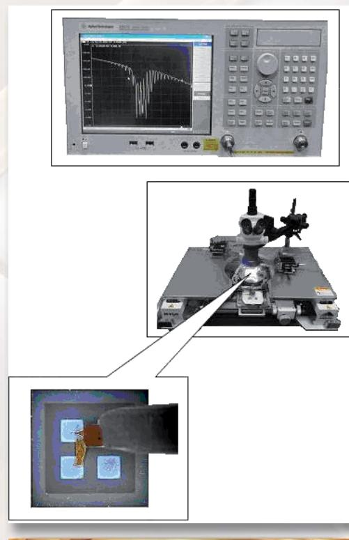
Анализатор цепей E5071C, рабочая станция M-150 и тестируемое устройство: ОАВ-резонатор
