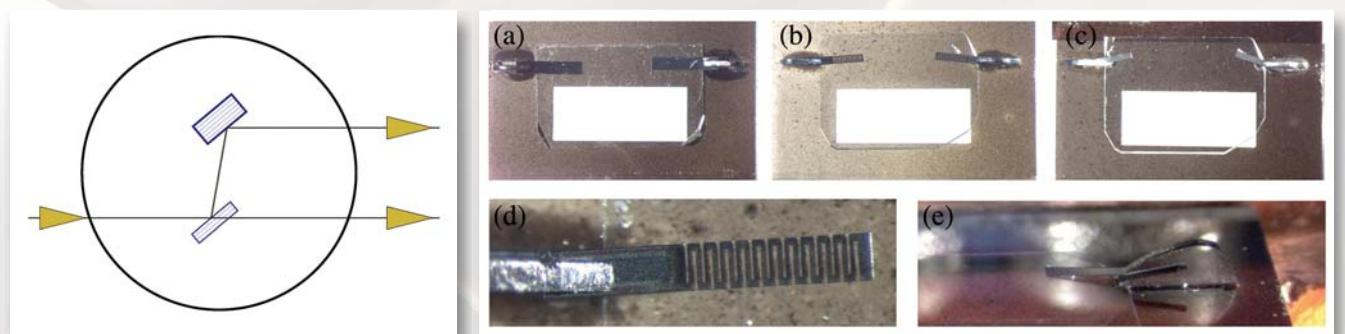
Алмазные компоненты для изготовления модуля двухкристального спектрометра и делителя пучка.
