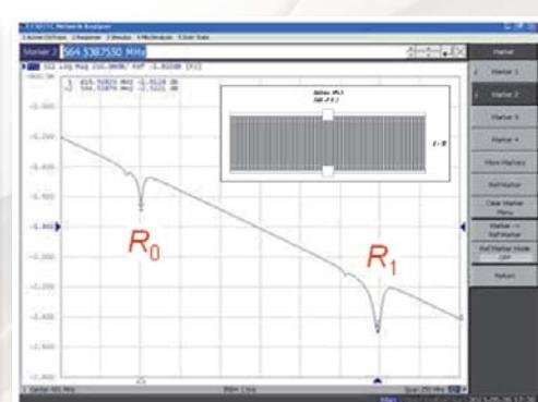
ОАВ-резонаторы на алмазной подложке со сложной конфигурацией электродов
