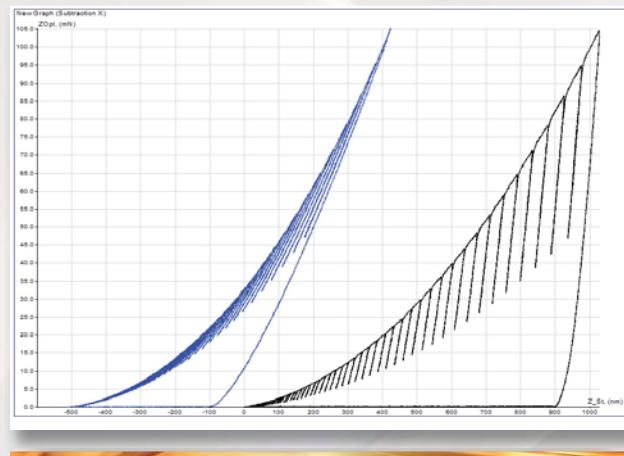
График сила нагружение - глубина для многоциклового укачивания,
