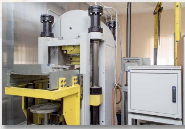
Установка УСУ-01/А для термобарической обработки и синтеза крупных монокристаллов алмаза, сверхтвердых и наноструктурированных материалов и обработки нанокомпозитов.
