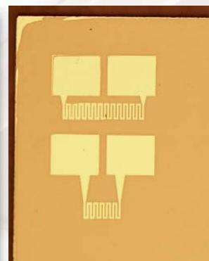
Структуры в держателях для исследования теплоемкости и теплопроводности алмаза
