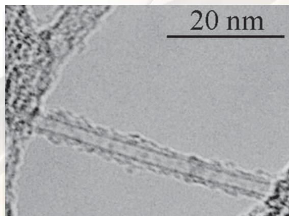
Фотированная одностенная нанотрубка.
