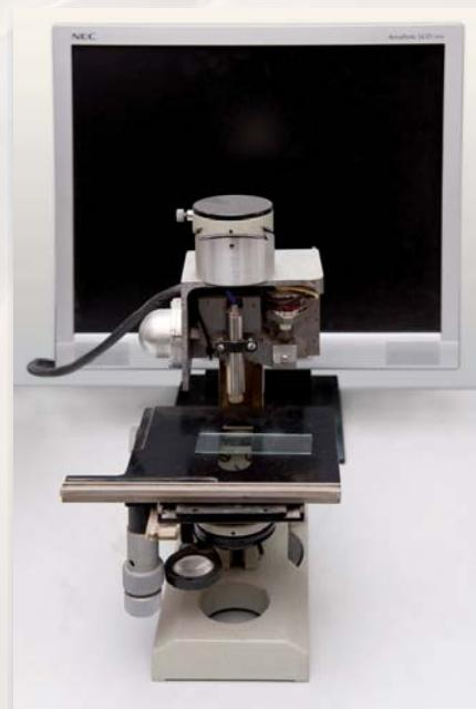
Высокочастотный импульсный акустический микроскоп (диапазон 25÷100 МГц)
