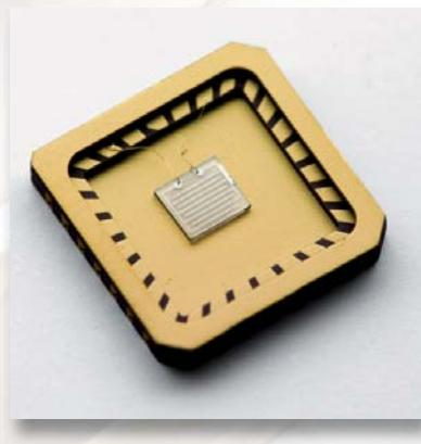
Чувствительный элемент датчика ультрафиолетового излучения
