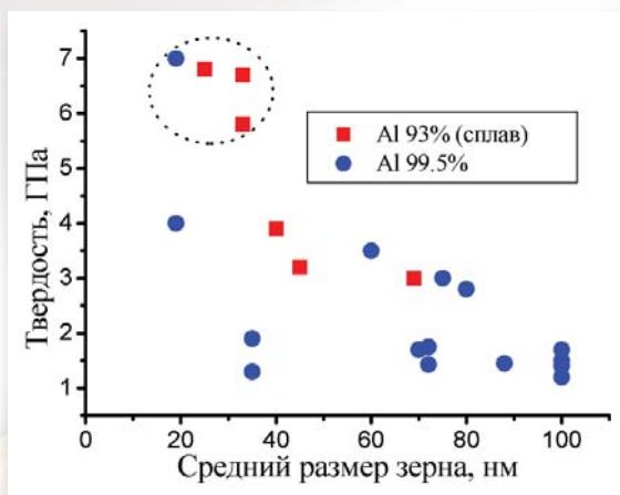
Для наноструктурированного алюминия, модифицированного  $C_{60}$ , достигнут теоретический предел сдвиговой прочности
