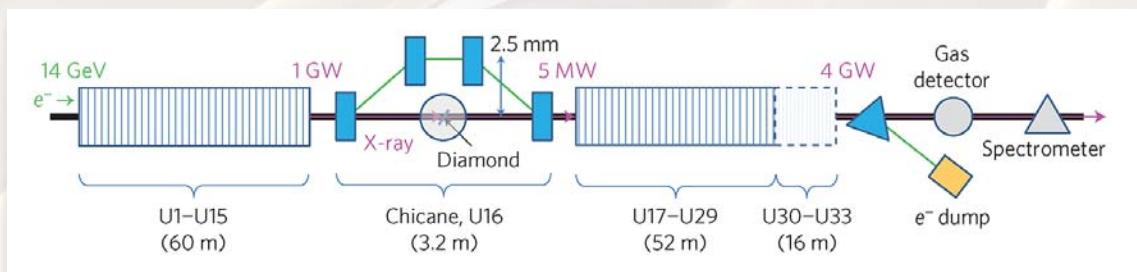
Схема лазера на свободных электронах с использованием монокристалла из синтетического алмаза для формирования импульса монохроматизированного рентгеновского пучка
